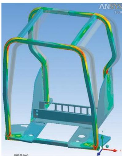
**Bild 3:** Die Belastungen der Stahlkonstruktion für die Kabine eines Traktors werden mit ANSYS analysiert.
