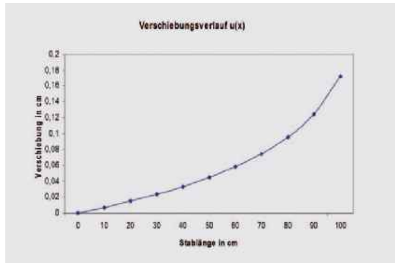
Bild 2: Analytische Lösung der Verschiebung über der Stablänge
