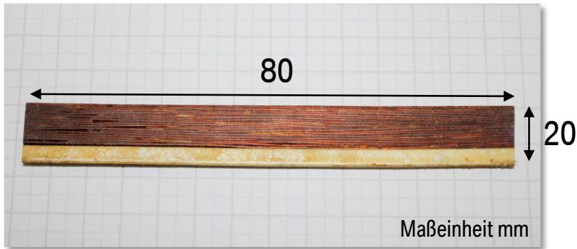
Abb. 6: Kupferwicklungsprobe aus einer Statornut entnommen (konischer Querschnitt, Tiefe 3,6 bis 5,3 mm).
