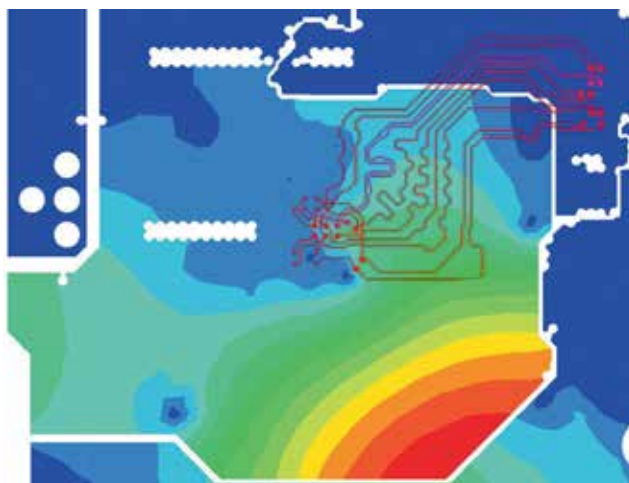
Bild 4: Feldverteilung in der Nähe von kritischen Signalleitungen: Eine Resonanz im Versorgungssystem wird angeregt.
