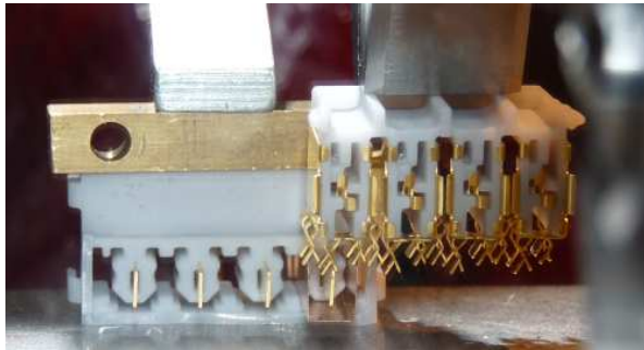
Fig. 7: Versuch – Steckkraftprüfung unmontiert
