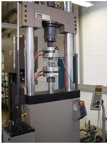
Versuchsaufbau: Stumpf ge- klebte Rohrprobe
